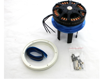
(f) Zykloldal: Voith-Schneider eVSP65BE.
