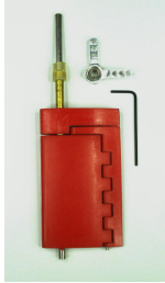
(d) Propeller + Ruder: Becker-ruder 70 mm.
